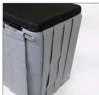
535-1770 Röntgenschutzset (grau) Maßgeschneiderter und montagefreundlicher Schutz gegen Streustrahlung mit Bleikautschuk (0,5 Pb). Detaillierte Informationen finden Sie in unserer Broschüre für Untertisch-Strahlenschutz
